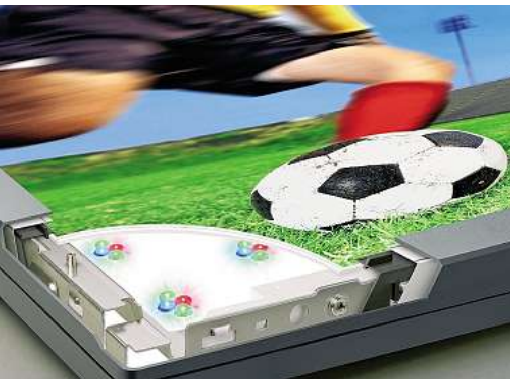
Bei grossen Display-Diagonalen ordnet man die LED in Viererkombinationen an (Bild Osram)
